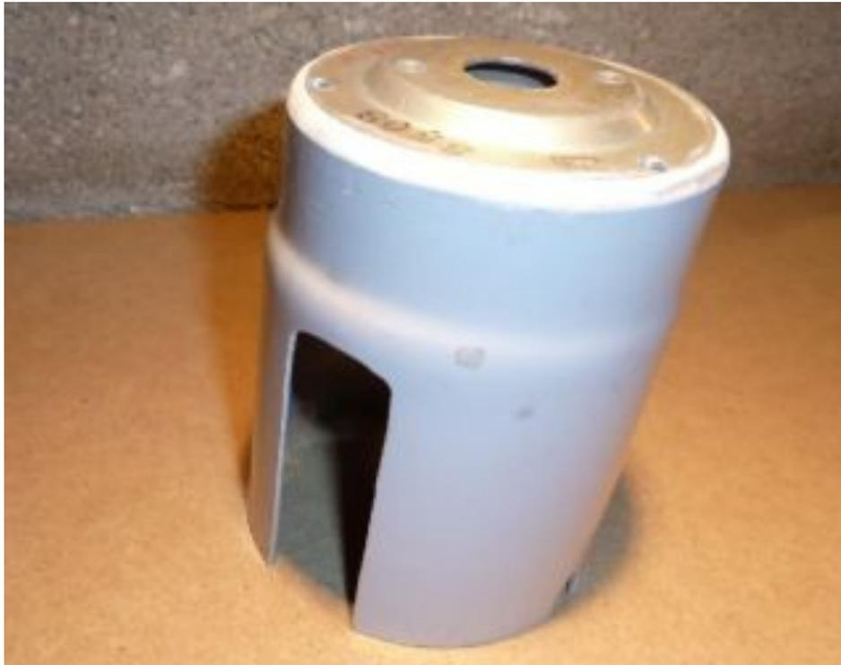
Pour les led il faut réaliser 3 tubes en alu et placer la led au fond de chaque tube, les tubes reçoivent à l'avant un petit disque trans lucide blanc découpé avec un emporte-pièce et collé à l'extrémité du tube Le système des tubes alu évite d'éclairer les fenêtres voisines.
