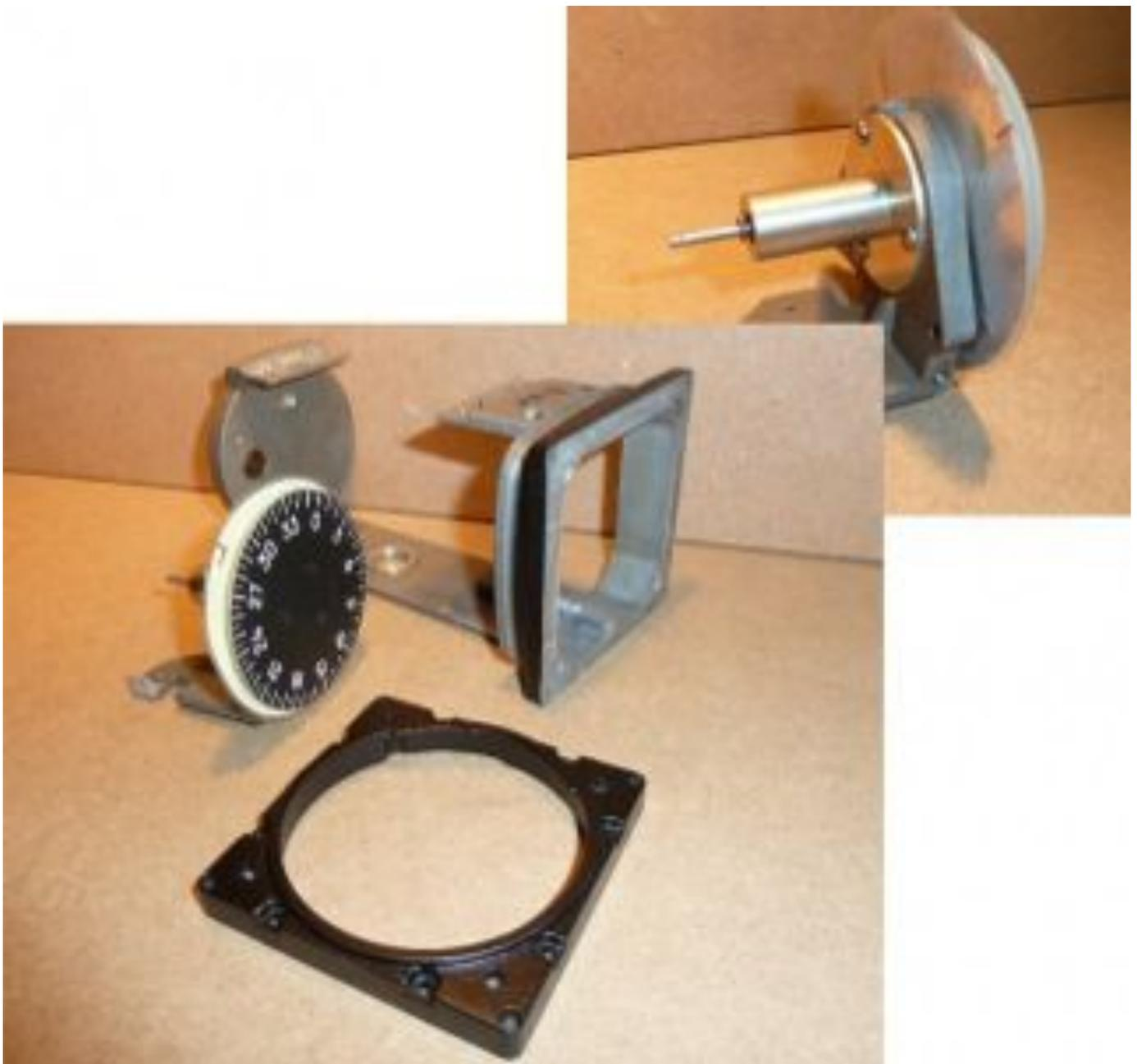
On fabrique les nouvelles pièces :support moteur,accouplement,support cellule (pour le calage du zéro)
