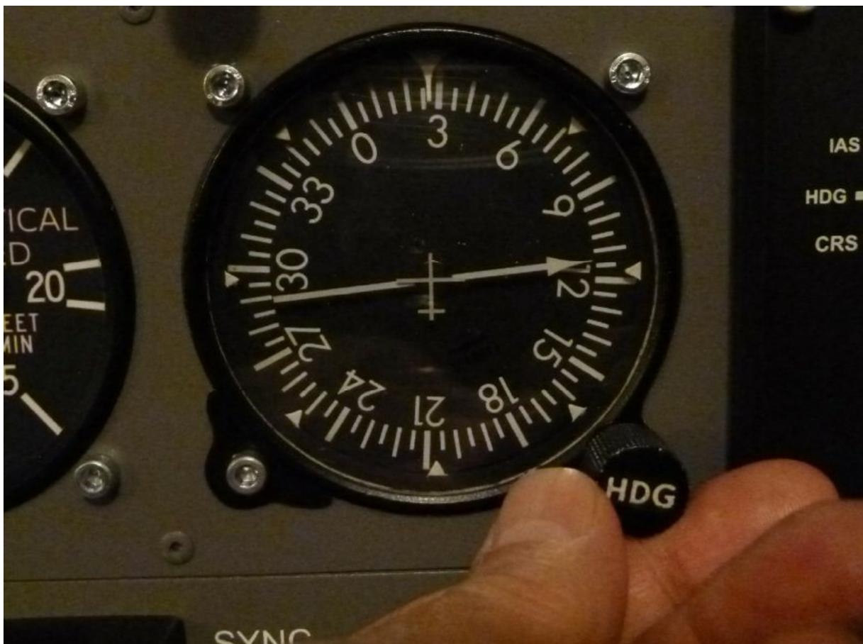
A noter que dans cet instrument , j'ai choisi de ne pas renvoyer pour l'instant la position du cadran commandé par le bouton HDG vers Fsx , mais c'est possible en utilisant un encodeur.
