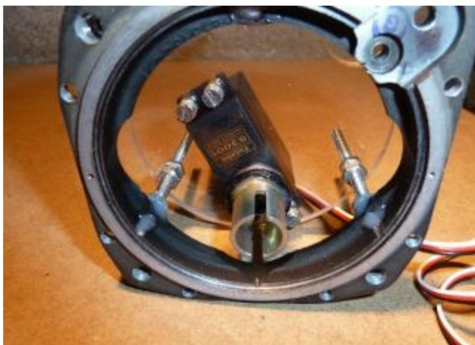
Pour le réglage de la radiale j'utilise un potentiomètre 10 tours commandé par le bouton d'origine qui entraîne donc aussi le cadran
