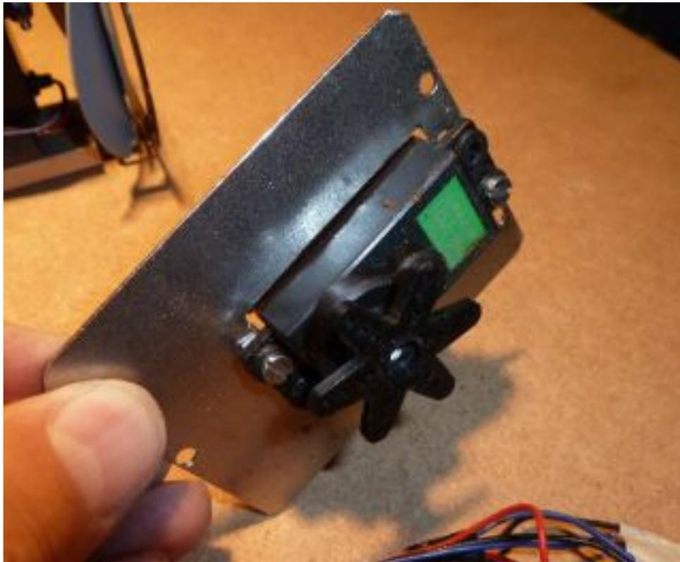
L'accouplement a été réalisé simplement avec un écrou à oreilles en laiton (écrou papillon), un peu retravaillé à la lime.
