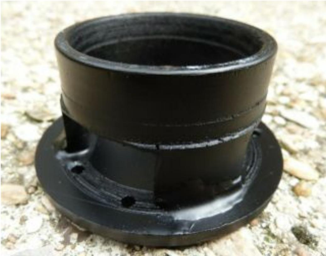
La cage recevant les pignons est réalisée avec 3 disques en plexi
