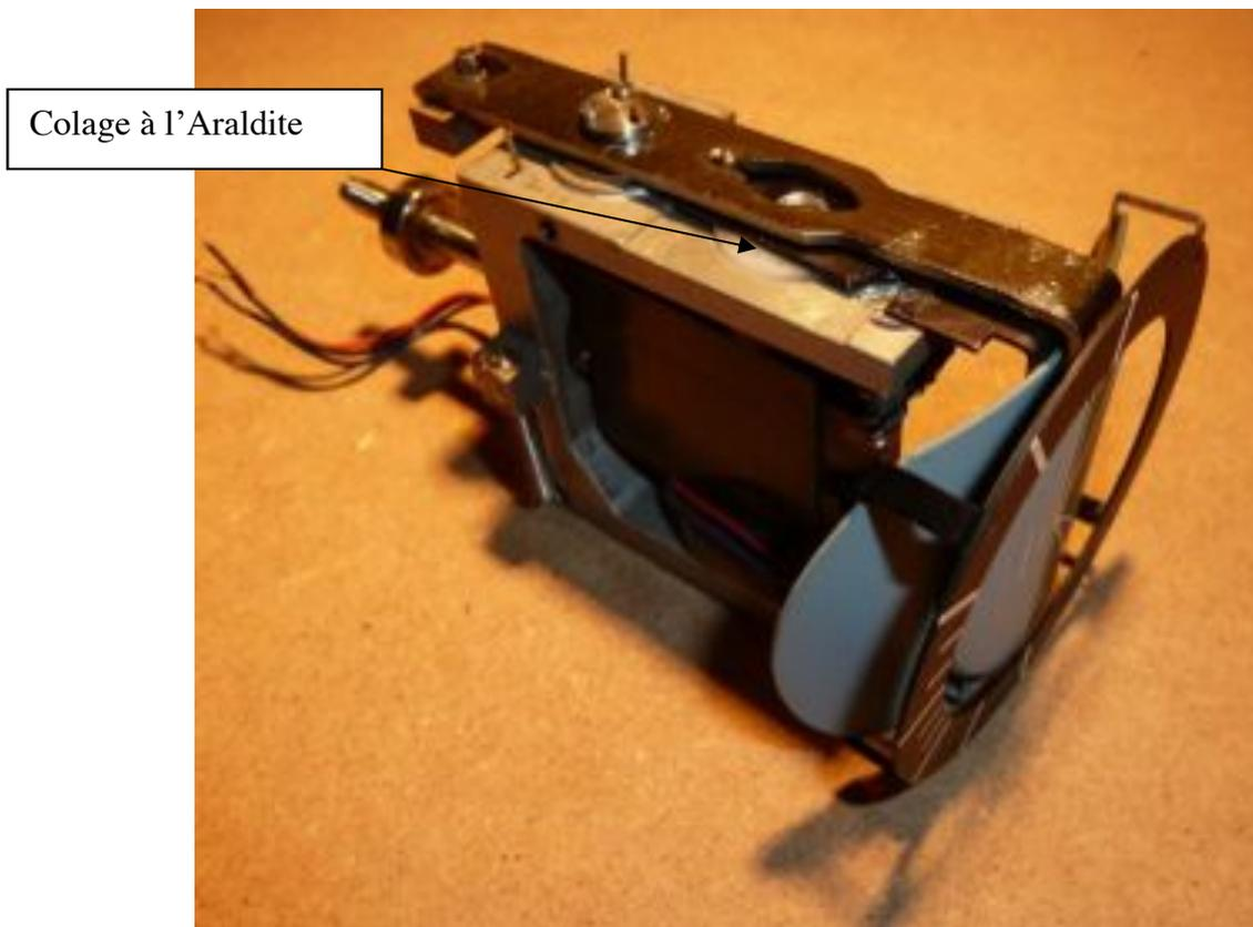
Une plaque pour le montage du servo AR est réalisée en acier ou alu (ici c'était en acier)
